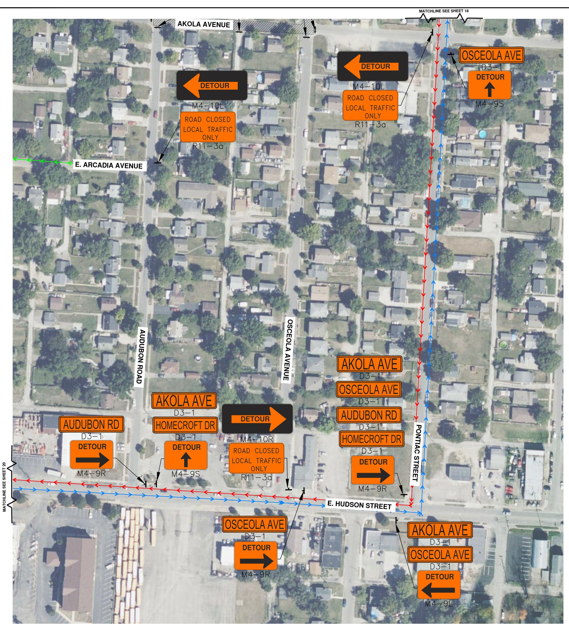
MATERIAL LIST CODE: QTY: STREET NAME D3-1 11 DETOUR — LEFT ARROW M4-9L DETOUR -STRAIGHT ARROW M4-9S DETOUR — RIGHT ARROW M4-9R DETOUR — LEFT ARROW M4-10L DETOUR - RIGHT ARROW M4-10R ROAD CLOSED LOCAL TRAFFIC ONLY R11-3A
